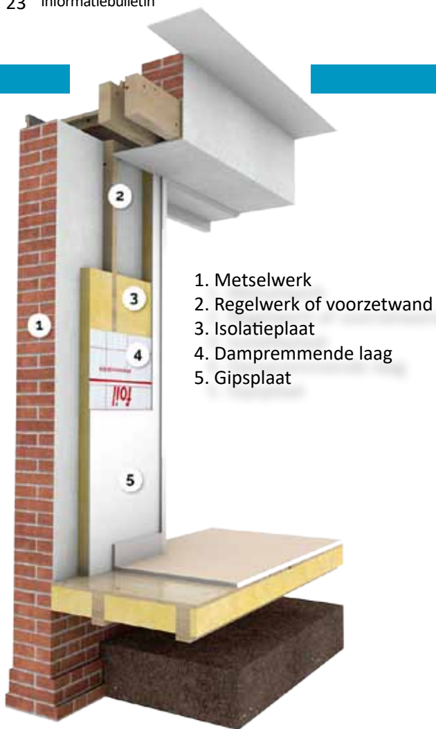
^ Binnenmuurisolatie dampdicht.
