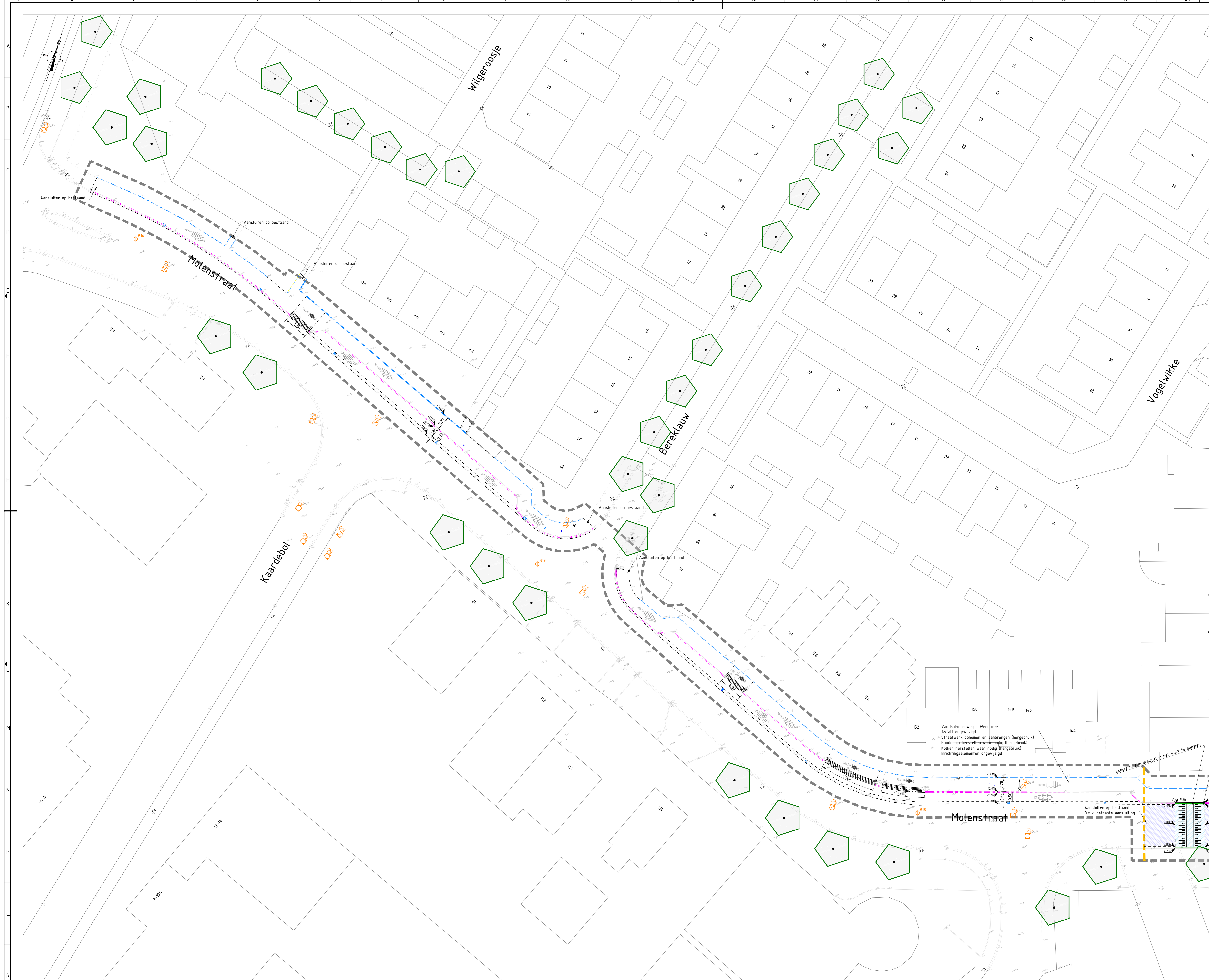
Overzicht 1.1: Heraanbrengen van het straatwerk. Geen asfaltwerk. Alles met hergebruik van vrijgekomen materialen. SCHAAL 1 : 200
